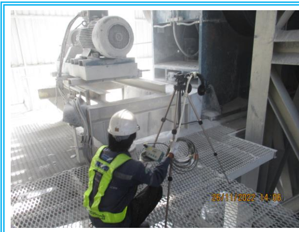
รูปที่ 4.3-7 แสดงการตรวจวัดค่าความทึบของฝุ่นละออง (Opacity) บริเวณปากโมชั้นที่ 2 วันที่ 26 พฤศจิกายน 2565
