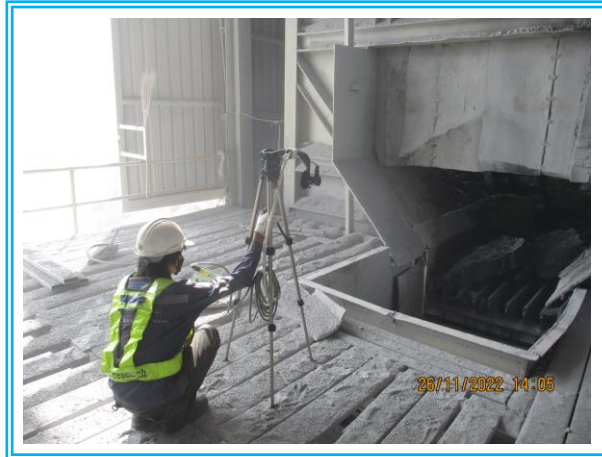
รูปที่ 4.3-6 แสดงการตรวจวัดค่าความทึบของฝุ่นละออง (Opacity) บริเวณปากโมหินใหญ่ วันที่ 26 พฤศจิกายน 2565
