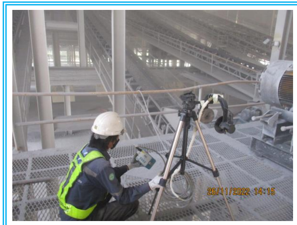
รูปที่ 4.3-8 แสดงการตรวจวัดค่าความทึบของฝุ่นละออง (Opacity) บริเวณตะแกรงคัดขนาด วันที่ 26 พฤศจิกายน 2565
