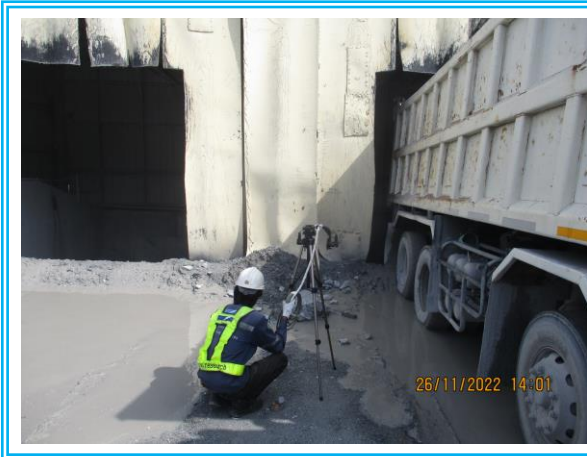
รูปที่ 4.3-5 แสดงการตรวจวัดค่าความทึบของฝุ่นละออง (Opacity) บริเวณยู่รับหิน วันที่ 26 พฤศจิกายน 2565
